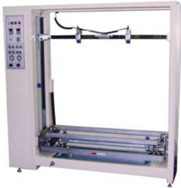
**MEDIAコーティングマシンMCM**は、従来、熟練作業者の経験に頼っていた乳剤の塗布工程を、自動化し、未熟練者にも使い易く設計、開発された全自動感光乳剤塗布装置です。
